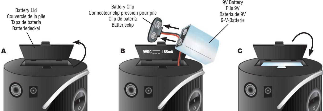
Complete steps 1 and 4, then install battery. / Suivre les étapes 1 et 4, puis installer la batterie. / Complete los pasos 1 y 4, luego instale la batería. / Führen Sie die Schritte 1 und 4 aus und installieren Sie die Batterie.
